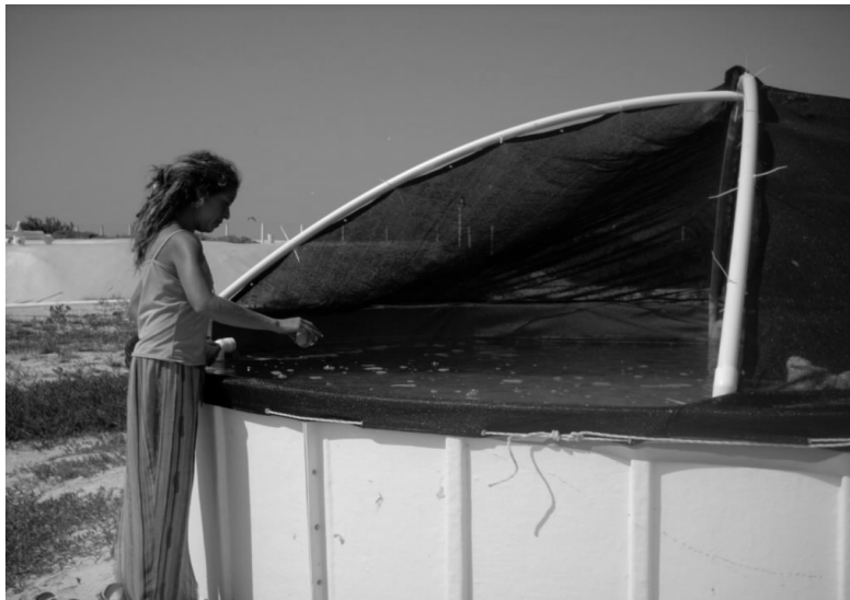
Figura 1. Imagen de estanques experimentales de mesocosmos con estructuras de PVC y malla sombra para disminuir la incidencia de luz.
