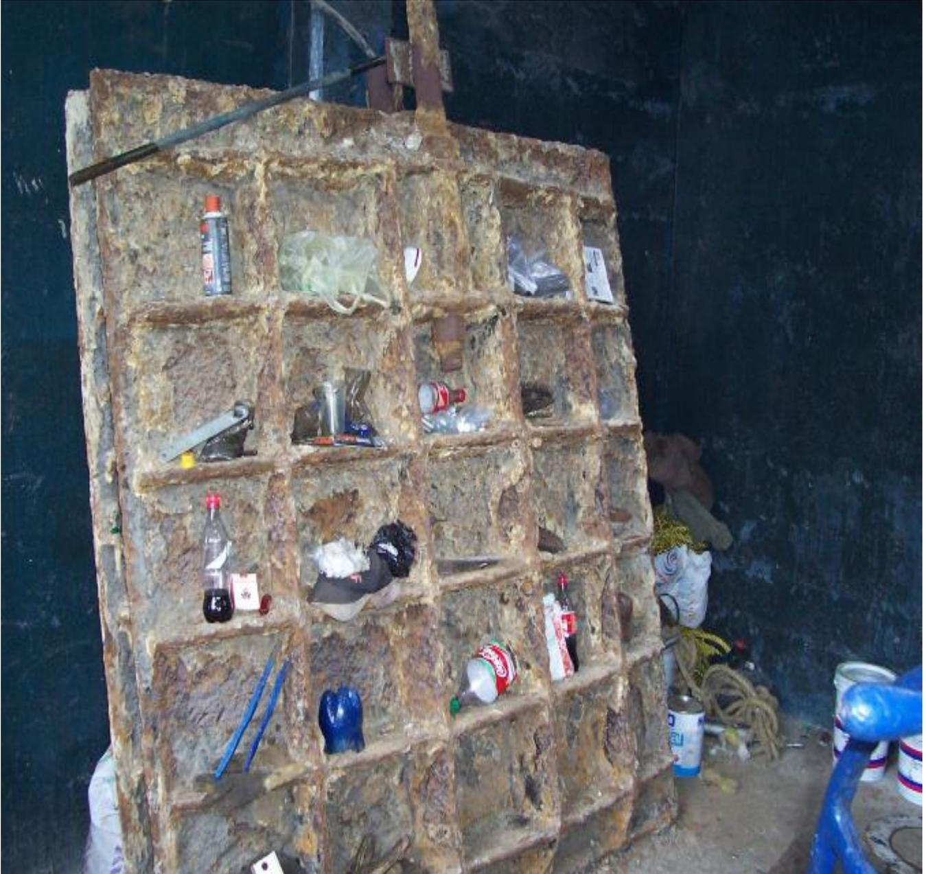
Las compuertas metálicas que permiten el control de los flujos de agua residual, son las principales estructuras que son afectadas por los efectos de corrosión, las grandes cantidades de desechos orgánicos son los factores principales en la generación de gases corrosivos.
