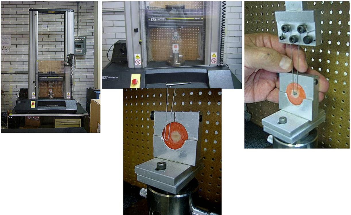
Figura 15. a y b. Máquina Universal de prueba Instron.
