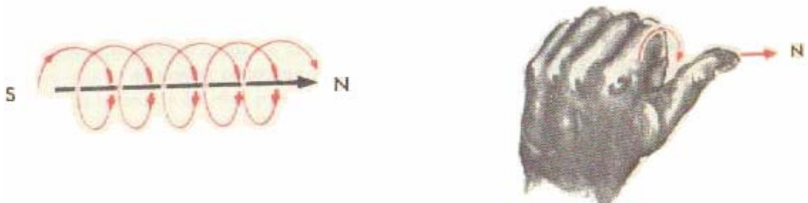
Fig. 2-5. Generación de campo magnético y regla de la mano izquierda.
