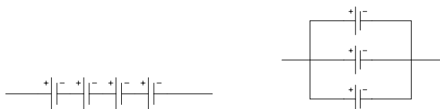
Figura 3. a) Celdas en serie b) Celdas en Paralelo
