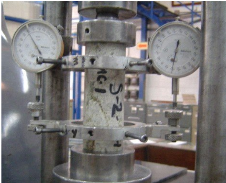
Figura 2.2. Micrómetros colocados sobre probeta en prueba de compresión simple con módulo de elasticidad 11
