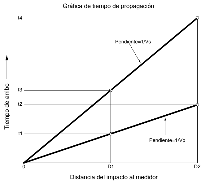
Fig. 3.14. Registro y cálculo de las velocidades de compresión y corte utilizando la gráfica de tiempo de propagación
