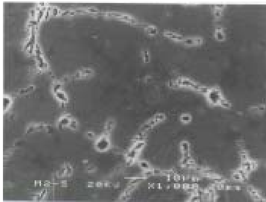
Foto 3 tomada a 60.00mm de la punta, el tamaño de la celda es de 35.0 \mu\text{m} , el análisis químico muestra \alpha Al (Al en forma de solución sólida), a X1000 aumentos. Se observa estructura dendrítica
