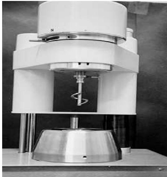
**Figura 2.4. Reómetro Haake modelo CV20N, con agitador helicoidal**
