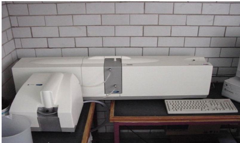
Figura 2.5. Analizador Malvern Mastersizer 2000s
