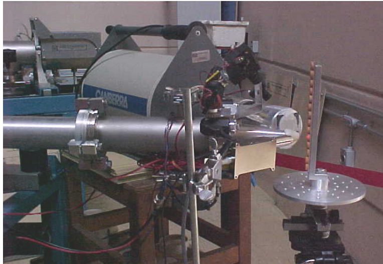
Figura B-7. Arreglo experimental usado al aire de PIXE. Acelerador Peletrón, Instituto de Física, UNAM.
