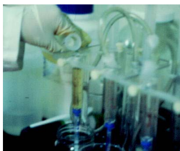
Figura 38. Equipo de filtrado con columnas aflatest
