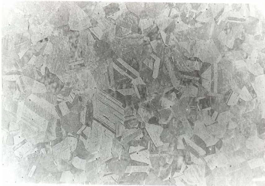
Figura 5.1.1.2. Fotografía de muestra testigo de acero 316L. Obtenida por microscopio óptico con amplificación de 100x, observamos granos semejantes y fronteras de grano bien delimitadas.
