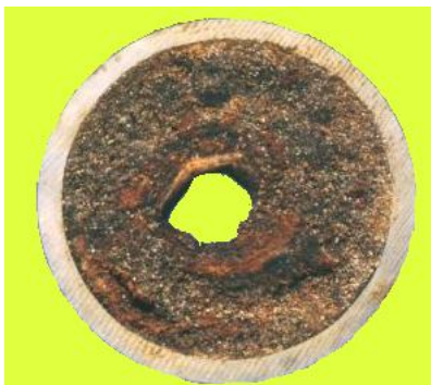
Figura I.1 Corte característico de una tubería de producción con severos problemas de depositación de parafinas.
