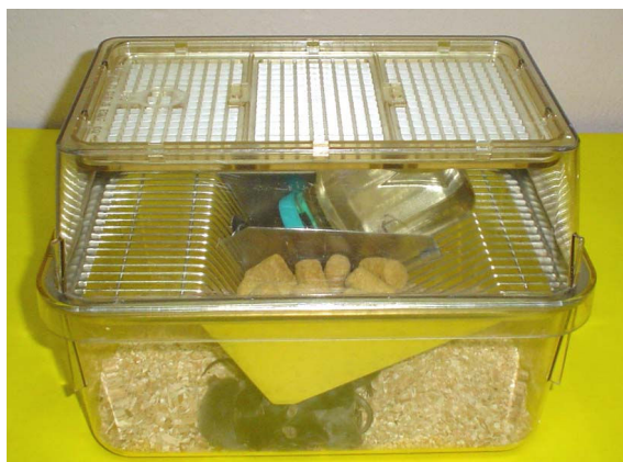
Figura 6. Foto de un microaislador donde se puede observar el filtro de la tapa y el contenedor metálico para colocar el agua y el alimento.
