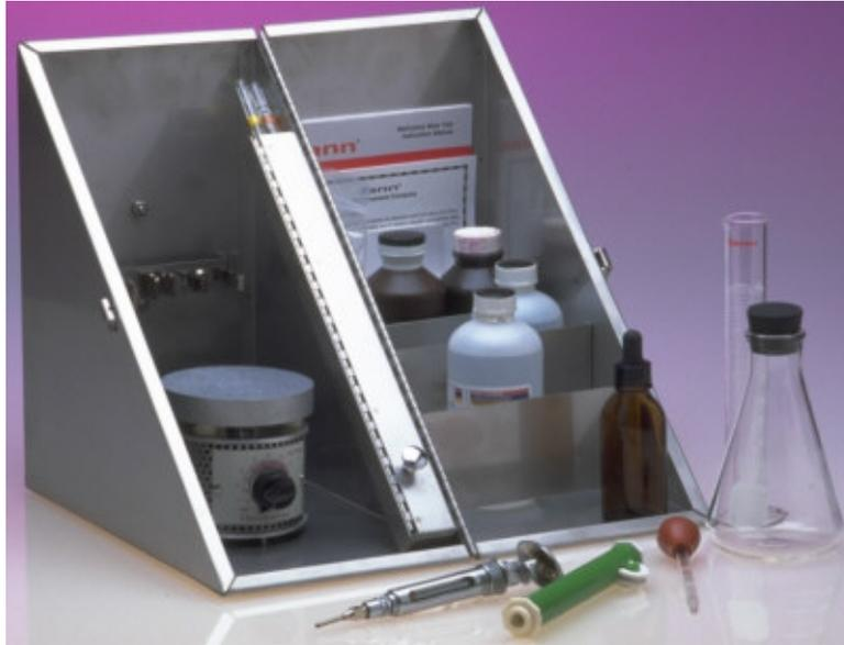
*Fig. 3.13 Equipo de azul de metileno*
