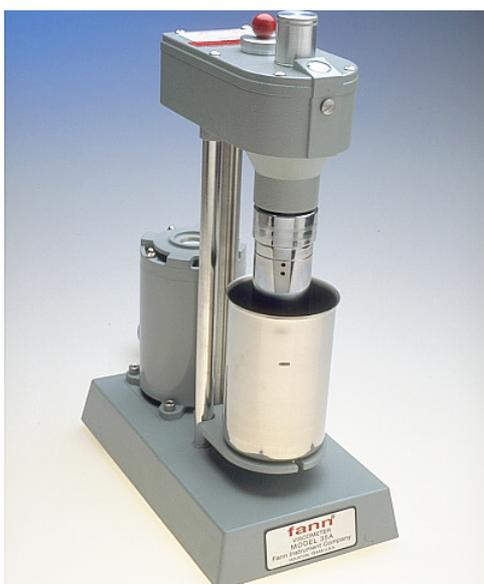
Fig. 3.4 Viscosímetro de indicación indirecta
