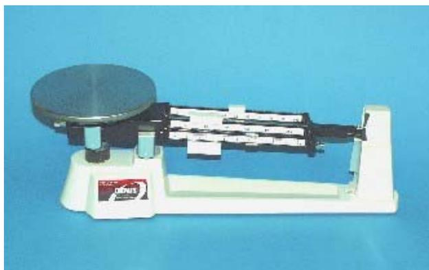
Fig. 3.8 Balanza de tres escalas de 0.01g. de precisión
