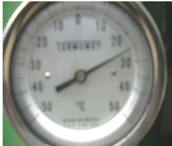
Fig.3.10 Termómetro bimetalico con conexión enroscada utilizado en este proyecto; rango  $\pm 50^{\circ}\text{C}$ .
