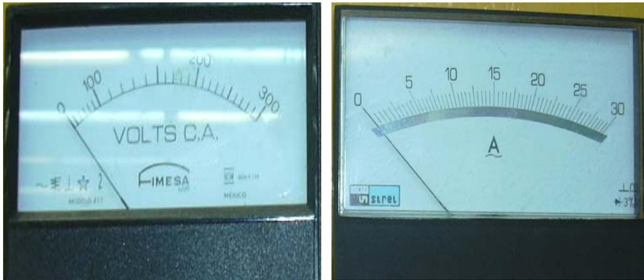
Fig.3.7 Voltímetro y Amperímetro utilizados en el proyecto marca FIMESA rango 0-300 Volts, 0-30 Amp. Respectivamente.
