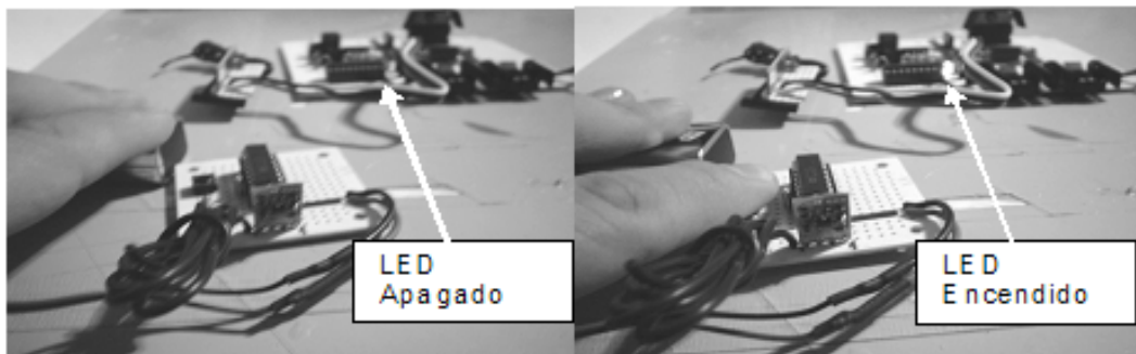
Figura 5.6 Prueba del mando Transmisor/Receptor.
