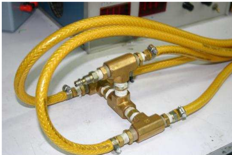
Figura #3.21. Conexiones de la sección de alta presión de la electroválvula.
