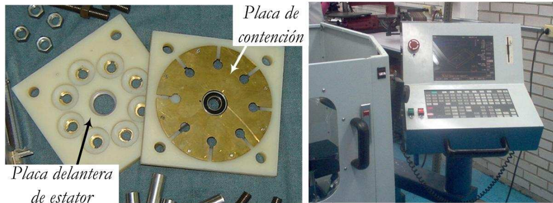
Figura #4.15. Manufactura de las placas frontales del motor en la fresa INMEC.
