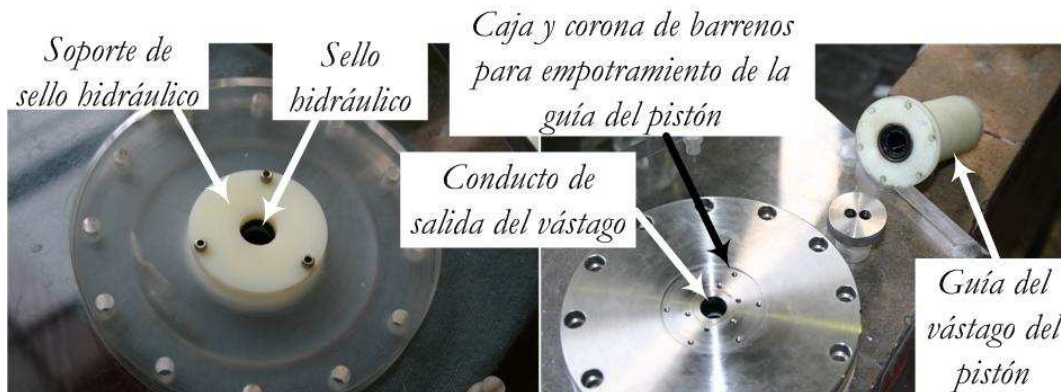
Figura #4.21. Manufactura de la tapa de la bomba de pistón y la guía del vástago.
