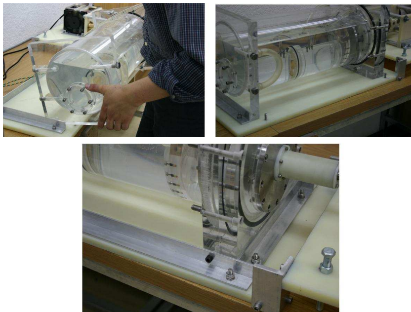
Figura #4.26. Sujeción del tanque al bastidor.
