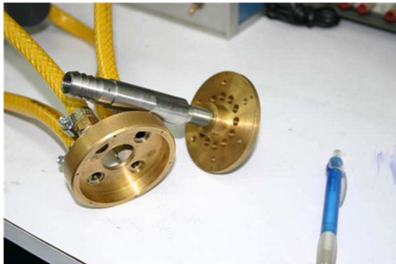
Figura #3.14. Cámara, inductor, anillo y tapas de la electroválvula.
