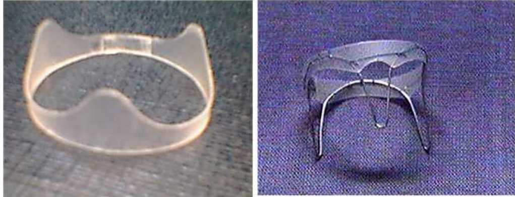
Figura #1.17. Soporte polimérico de las bioprótesis (izquierda). Acoplamiento de la estructura alámbrica con el soporte polimérico (derecha).
