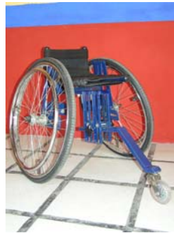
Fotos 3.5.-Simulador de silla de ruedas que varía el ancho y alto del asiento y respaldo, ángulo de las llantas (camber), y posición del eje de las llantas traseras.
