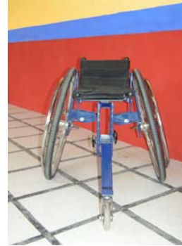
Fotos 3.5.-Simulador de silla de ruedas que varía el ancho y alto del asiento y respaldo, ángulo de las llantas (camber), y posición del eje de las llantas traseras.
