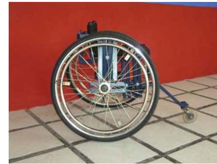
Fotos 3.5.-Simulador de silla de ruedas que varía el ancho y alto del asiento y respaldo, ángulo de las llantas (camber), y posición del eje de las llantas traseras.
