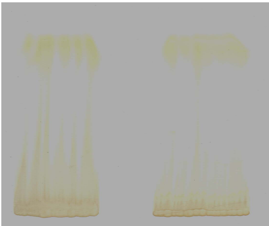
Fig. 26 Cromatografía en capa fina ( der. P. calyculatus ETOH sol. Agua e Izq P. villosum sol. agua.)
