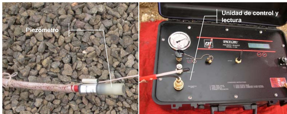
Figura No. 7.12.- Fotografía con el piezómetro neumático propuesto.
