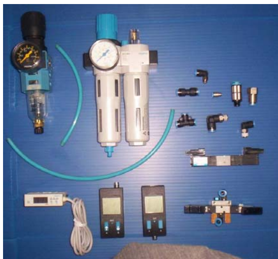
Figura 33. Componentes neumáticos y electrónicos del banco de pruebas
