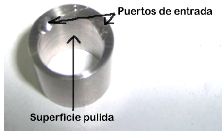
Figura 45. Detalles de manufactura del estator
