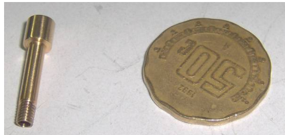
Figura 30. Tubo auxiliar para conexión de racor
