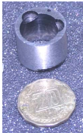
Figura 19. Estator manufacturado de acero inoxidable
