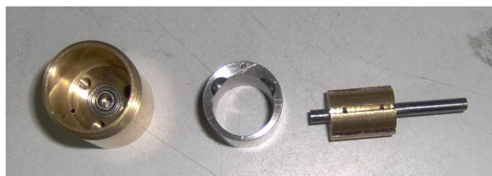
Figura 23. Partes principales del micromotor
