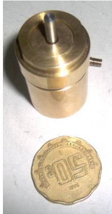
Figura 29. Carcasa manufacturada en latón
