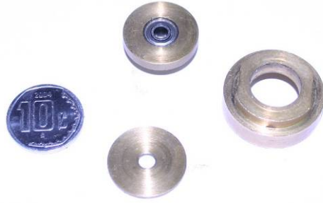
Figura 49. Partes auxiliares del segundo diseño de micromotor neumático de aspas sin resortes.
