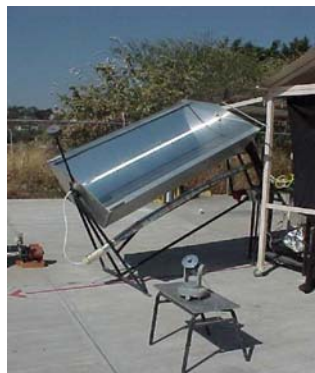
Figura 2.3. a) Concentrador cilindro-parabólico Helioman con seguimiento en dos ejes para aplicaciones de fotocatalisis (PSA-CIEMAT), b) DICEF con seguimiento, instalado en la plataforma de concentración solar (CIE-UNAM).
