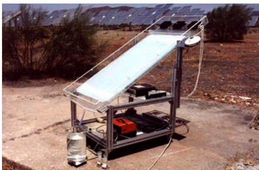
Figura 2.1. Instalación experimental de un sistema de placa plana (PSA).
