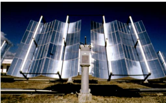
Figura 2.3. a) Concentrador cilindro-parabólico Helioman con seguimiento en dos ejes para aplicaciones de fotocatalisis (PSA-CIEMAT), b) DICEF con seguimiento, instalado en la plataforma de concentración solar (CIE-UNAM).
