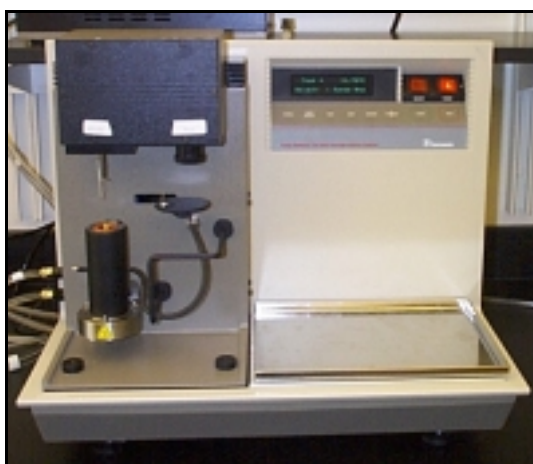
Figura 2.14. Analizador Termogravimétrico TA Instruments modelo 2950.
