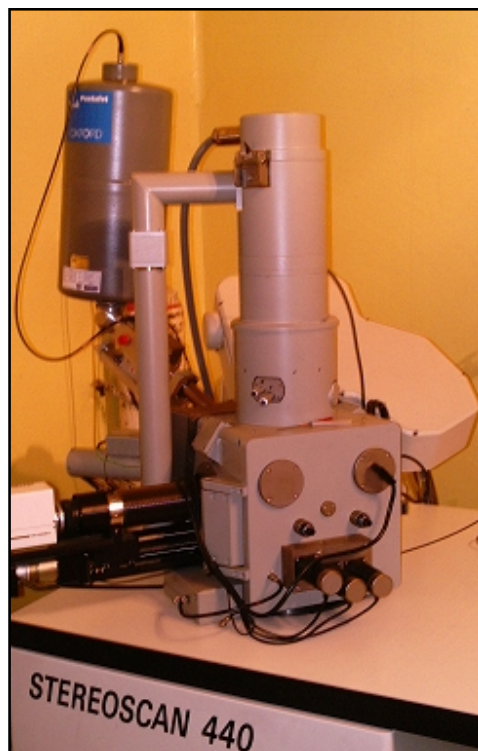
Figura 2.13. Microscopio Electrónico de Barrido Cambridge Stereoscan 440.
