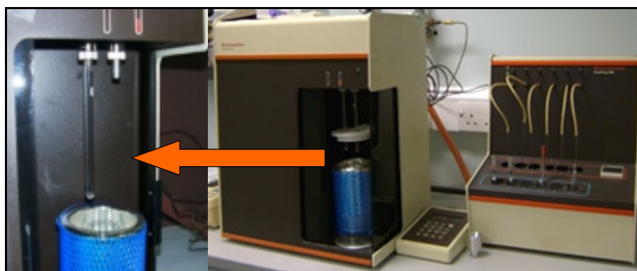
Figura 2.15. Analizador BET Micromeritics Gemini 2360.
