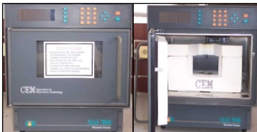
Figura 2.9. Fotografías del horno de microondas CEM Modelo MAS 700 Microwave Furnace.
