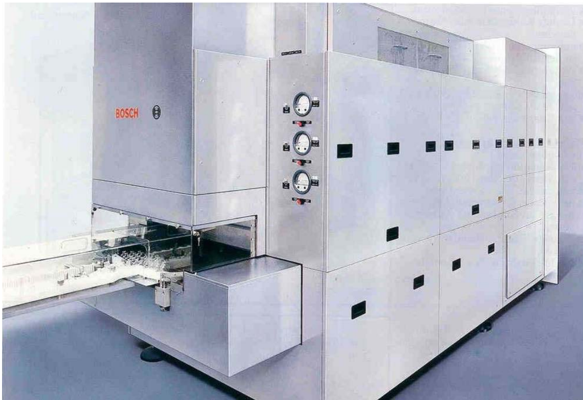
Figura 9-20. Túnel de despirogenización Bosch® SQL. Este equipo aplica aire a una temperatura de 350°C para reducir el tiempo de esterilización. ( www.boschpackaging.com )
