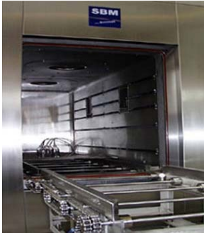
Figura 9-14. Imagen de una cámara de esterilización por vapor de agua SBM®. ( http://www.boschpackaging.com )
