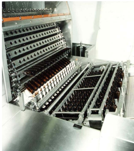
Figura 9-19. Sistema automatizado en serie de lavado de envases Bosch® RQN. ( http://www.boschpackaging.com )
