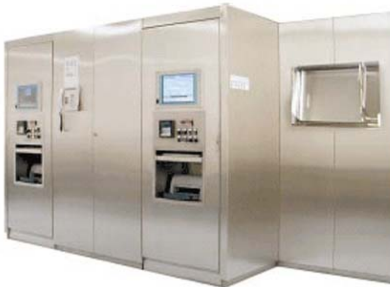
Figura 9-18. Lavador y esterilizador de tapas de elastómero SBM®. ( http://www.boschpackaging.com )
