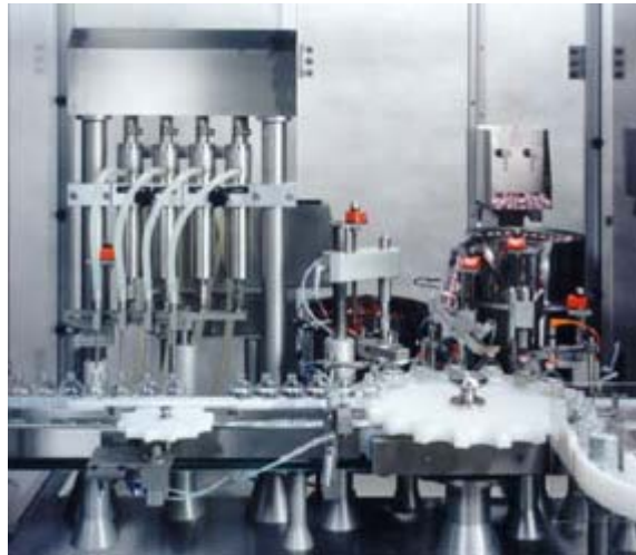
Figura 9-23. Imagen de un equipo de llenado Bosch® MRF que emplea un sistema de pistón. ( www.boschpackaging.com )
