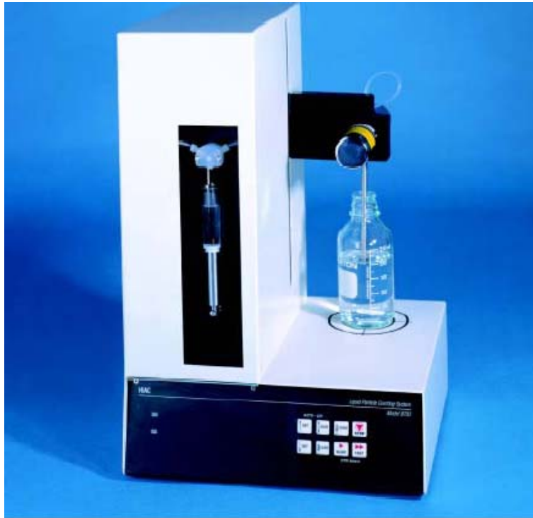
Figura 9-17. Imagen de un equipo de conteo de partículas HIAC® 9703. ( www.particle.com )
