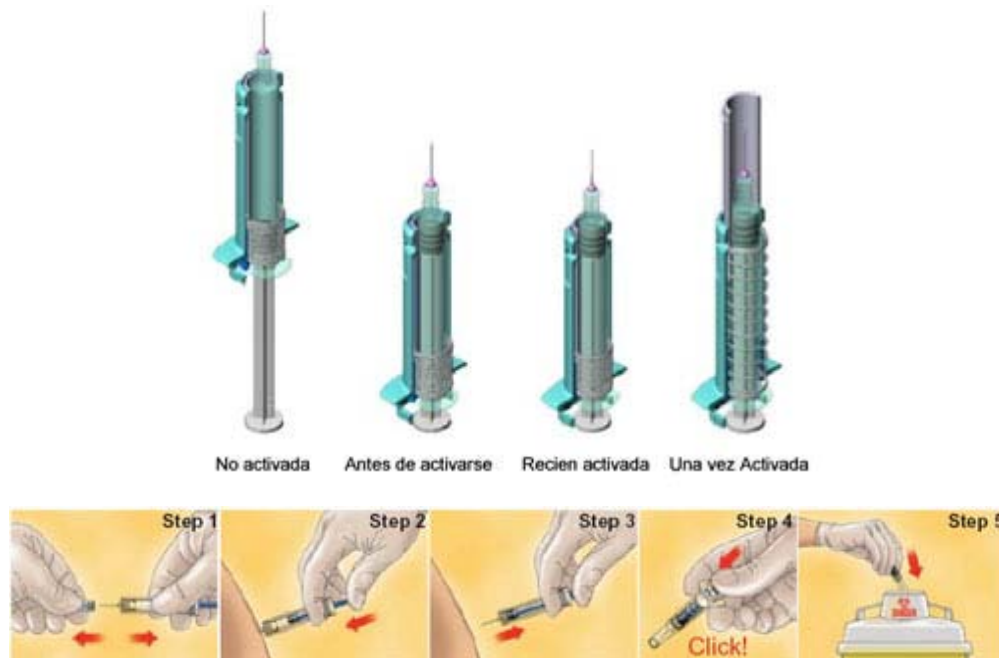
Figura 1-15. Mecanismo de operación y método de aplicación de una inyección con una jeringa equipada con el sistema Hypak®. 1) Se remueve la tapa, 2) Se aplica la inyección, 3) Se retira la jeringa, 4) Se activa la protección y 5) se desecha la jeringa. (Hypak, http://www.bdpharma.com , Pp. 2)
