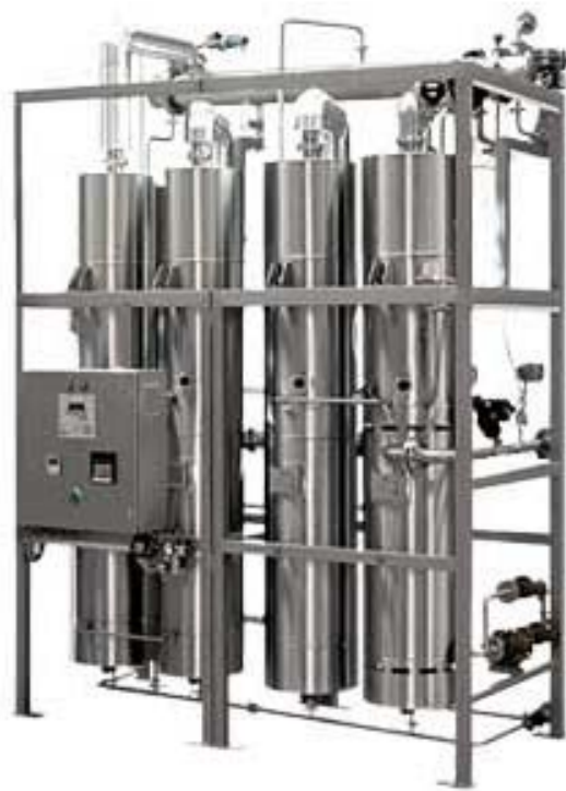
Figura 7-16. Imagen de un destilador de agua para inyección. ( http://www.boschpackaging.com , Mayo 16, 2005)
