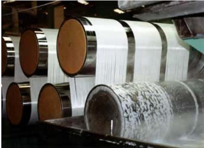
Equipo de rodillos de estirado a través de temperatura con vapor.
