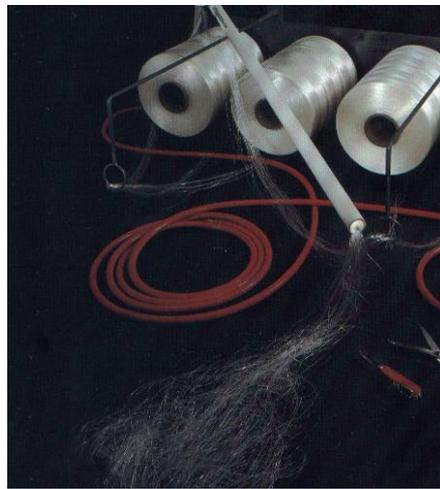
Sistema Landstrand de aire para la aplicación de hilos sintéticos en forma desordenada.
