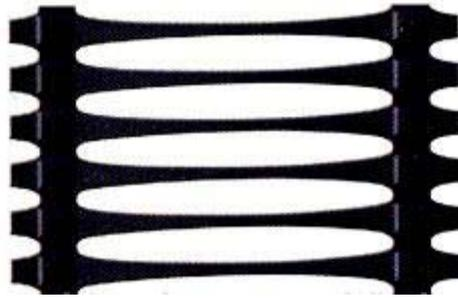
El resultado final es una georred orientada uniaxialmente con una geometría común.
