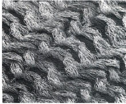
Como puede verse en la superficie superior de la tela, la inserción del multifilamento es evidente, sin embargo, cuando se ve la parte inferior, la superficie es predominantemente una superficie con tejido de punto con multifilamentos escasamente visibles.
