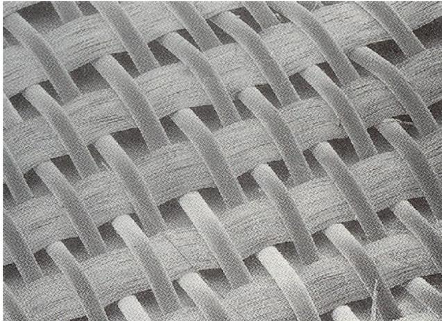
Tejido multifilamento sobre monofilamento.
