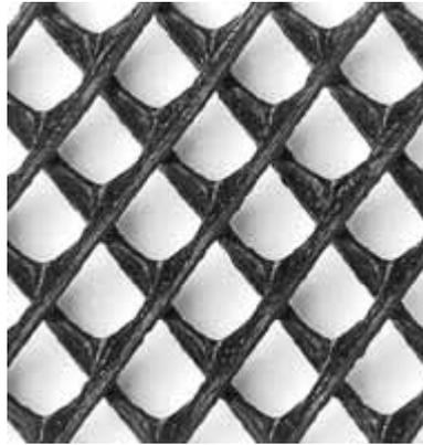
Fotografía superior de georred extruída no orientada.
