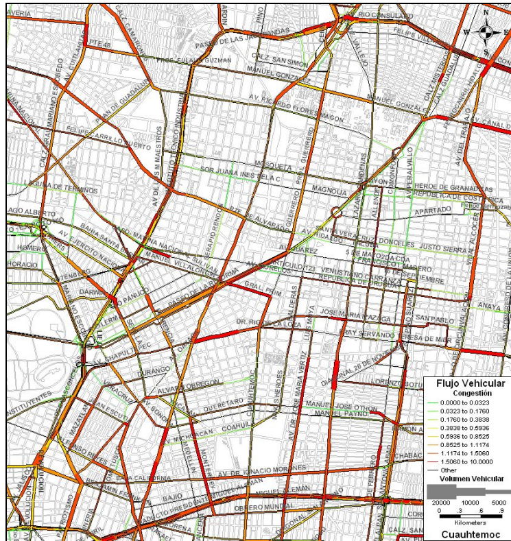
Figura 3. 36. Caracterización del Flujo Vehicular para la delegación Cuauhtémoc. Fuente: Elaboración propia con datos del LTST – IINGEN, UNAM.
