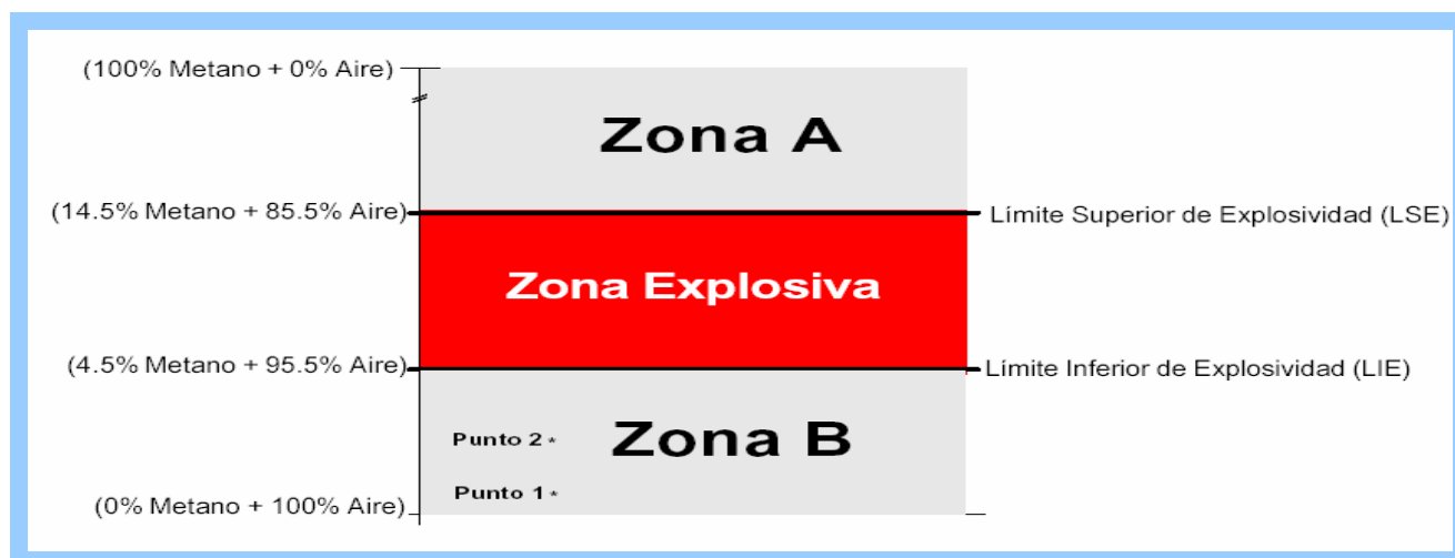
Figura 20. Representación de la zona explosiva de gas natural formada por el mismo más la presencia de aire. [8]
