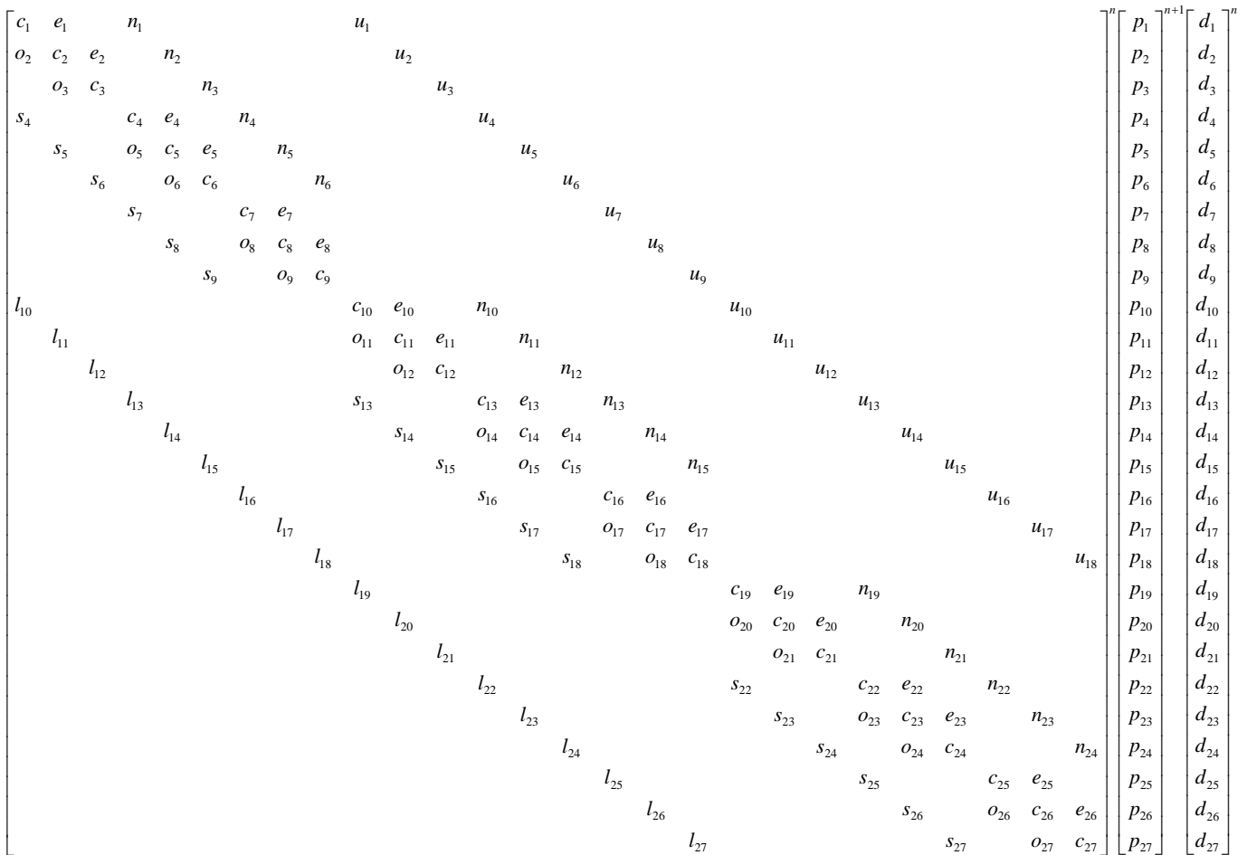
Figura 2.7. Esquema de una matriz de coeficientes para una malla de 3x3x3 (Hernández R., O. y Del Valle M., P.).
