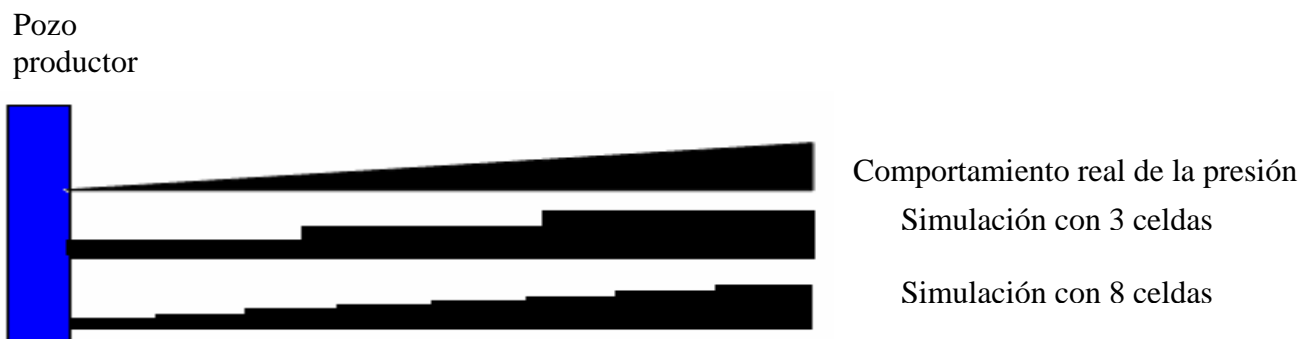
Figura 2.3. Representación de la presión en el yacimiento de forma real y discretizada.
