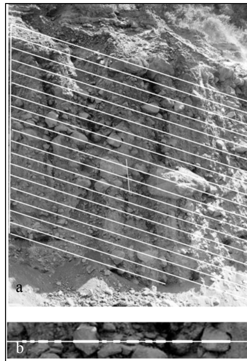
Figura 5.1. a) Ejemplo de un afloramiento al que se le sobrepone la rejilla utilizada por el método de Rosiwal; b) se muestra la intersección entre la línea de medición y los rasgos del afloramiento (clastos).
