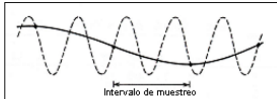
Figura VI.6. Ejemplo de aliasing . Una onda sinusoidal de alta frecuencia (línea discontinua) muestreada con un intervalo constante, proporciona frecuencias aparentemente pertenecientes a una onda de frecuencia más baja (línea continua).
