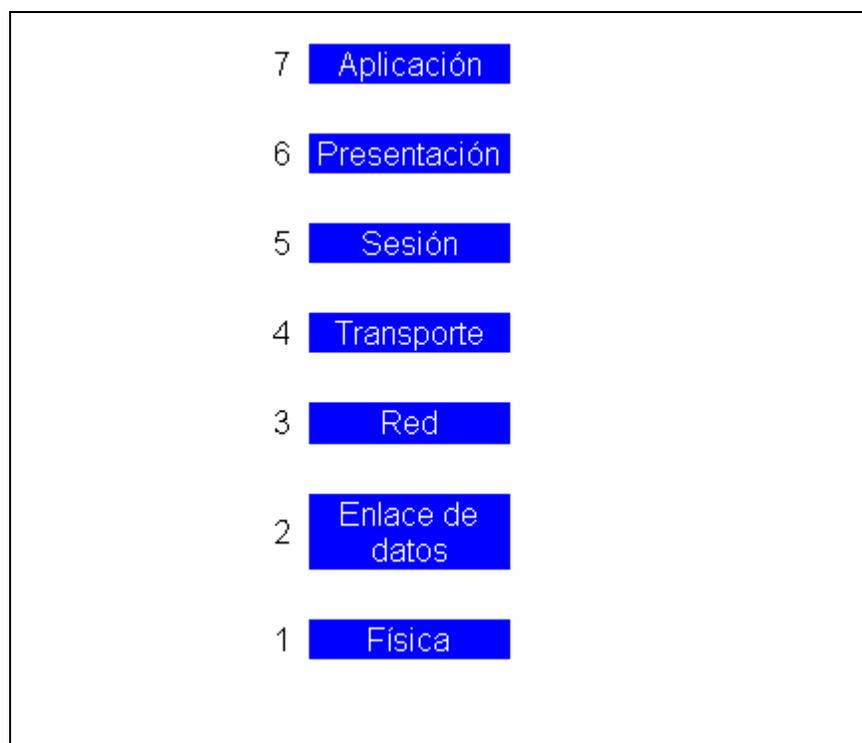
**Figura 2.10** Capas del modelo OSI.
