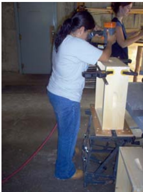
Fig.14 Ensamblado de alzas por medio de grapas a presión
