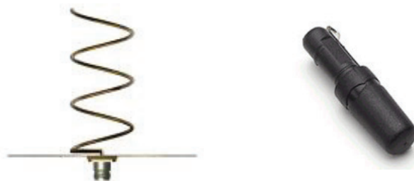
Figura I.19. Diagrama de una antena dipolo helicoidal para MS y su implementación física.
