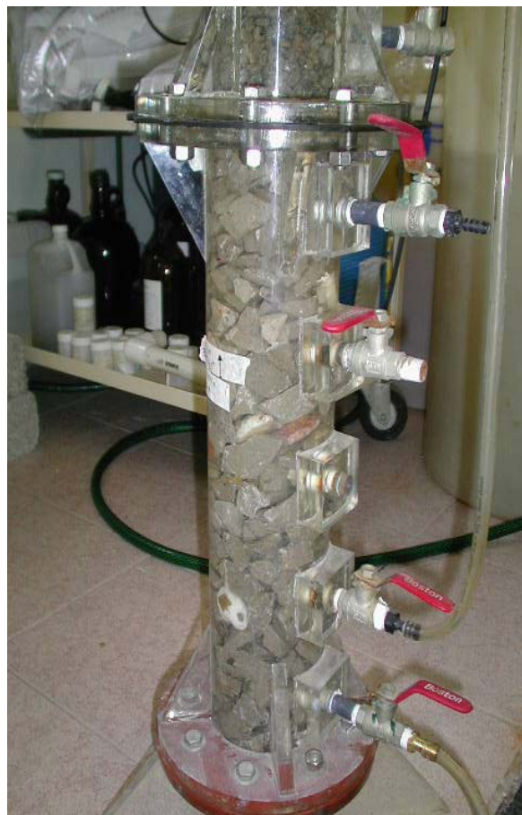
Se muestran las probetas con el agua turbia de lluvia pasando por las diferentes capas de filtros, cuya granulometría va disminuyendo.
