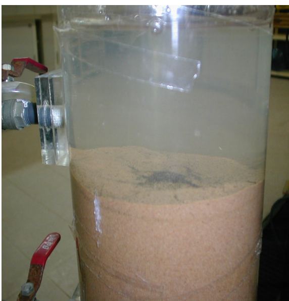
Material filtrante de menor granulometría.
