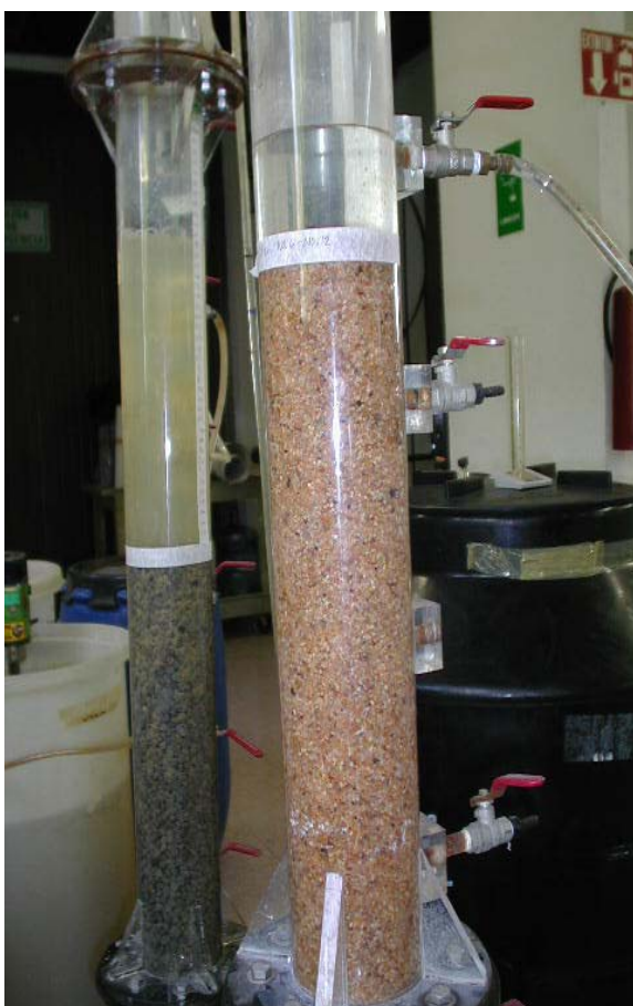
Se muestran las probetas con el agua turbia de lluvia pasando por las diferentes capas de filtros, cuya granulometría va disminuyendo.
