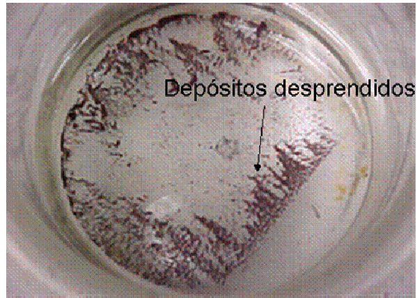
Figura 4.2. Depósitos desprendidos en el fondo del RCE
