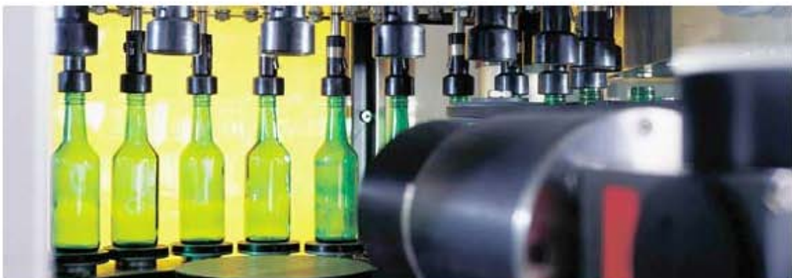
Figura 2.3.7 Detalle de un inspector electrónico de envases. Cámara para cuerpo.
