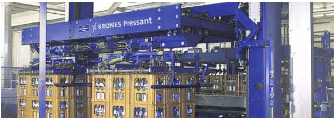
Figura 2.3.11 Formadora de tarimas.
