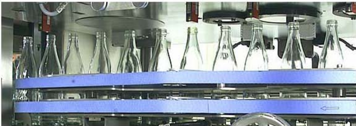
Figura 2.3.6 Detalle de un inspector electrónico de envases. Cámaras para fondo y boca.
