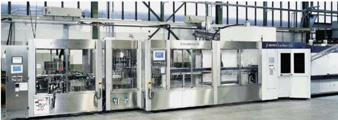
Figura 2.3.13 Llenadora de envases PET no retornables.
