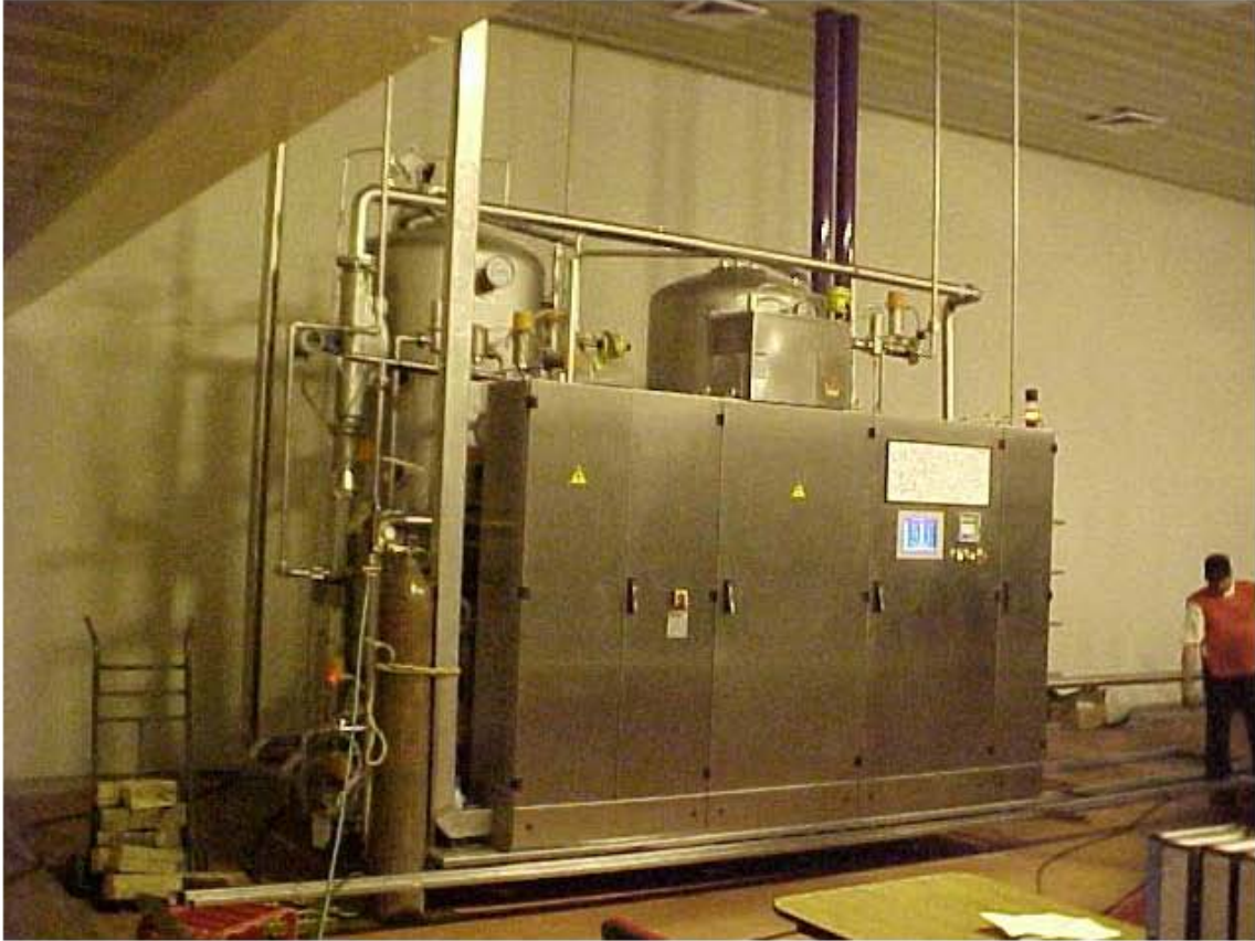
Figura 2.4.2 Equipo mezclador y carbonatador para temperaturas de 12°C
