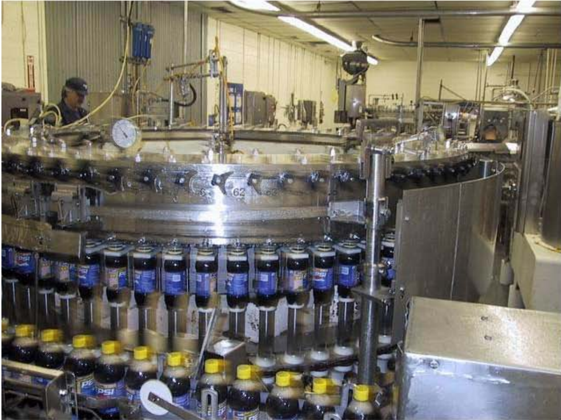
Figura 2.4.6 Zona de desfogue de la llenadora y transportador de salida de producto.
