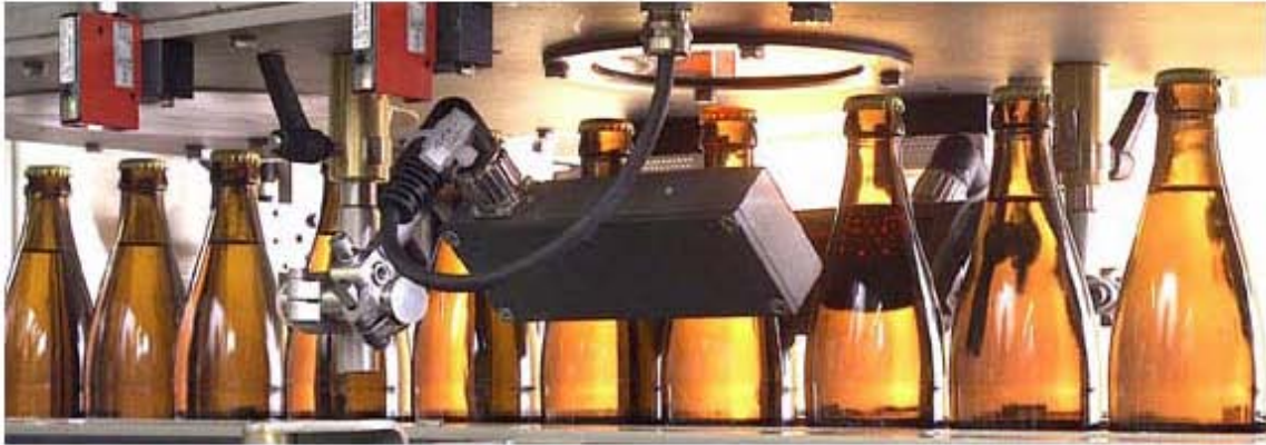
Figura 2.3.8 Inspección de altura de lleno y presencia de corona
