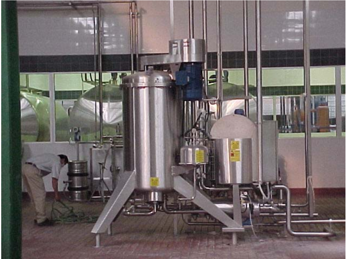
Figura 2.2.2 Filtro de placas horizontales.
