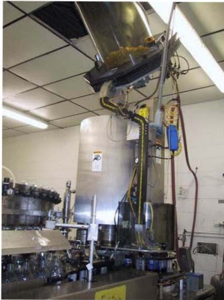
Figura 2.4.9 Tolva de alimentación al capsulador.
