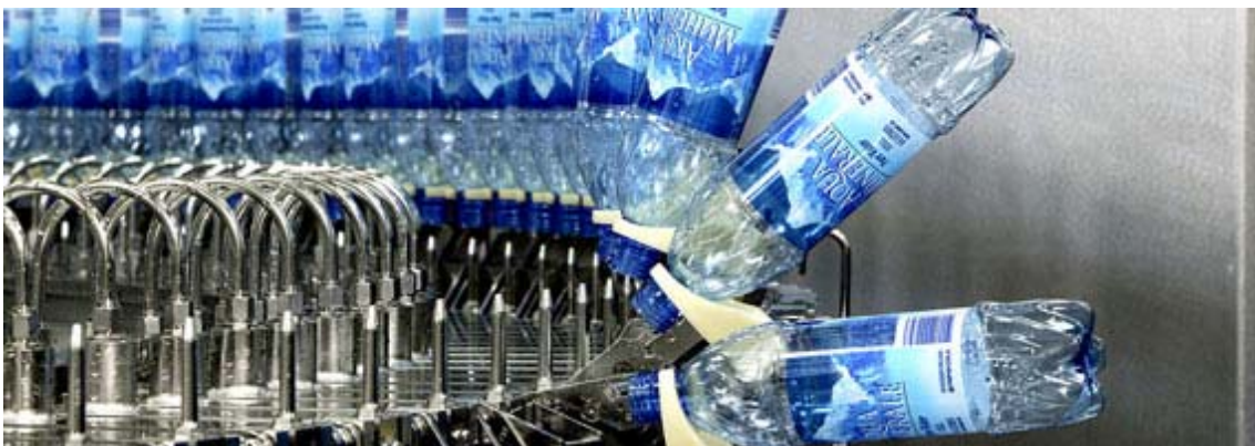
Figura 2.3.14 Enjuagador de envases PET no retornables.
