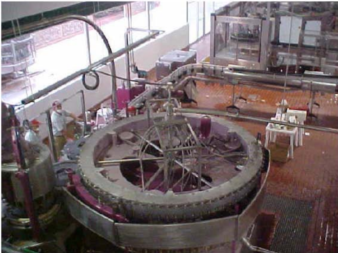
Figura 2.4.4 Llenadora para vidrio retornable.
