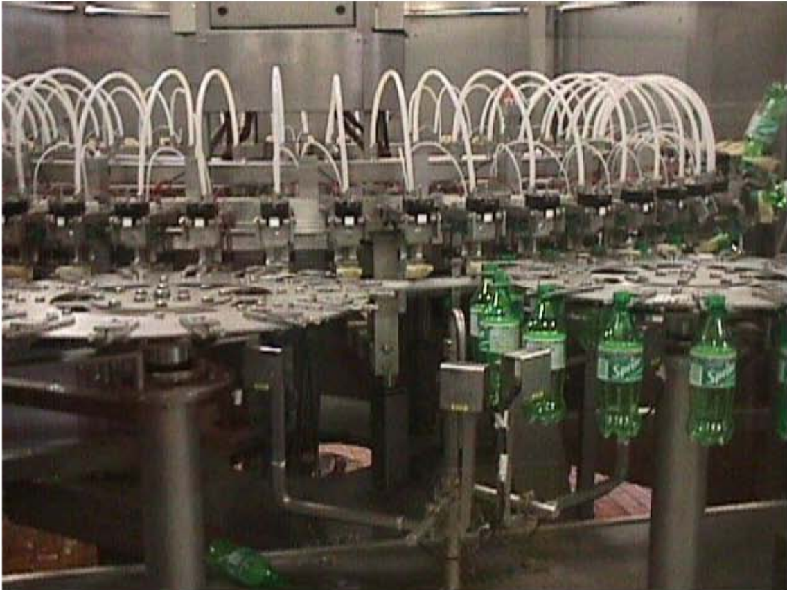
Figura 2.3.15 Enjuagador de aire ionizado.
