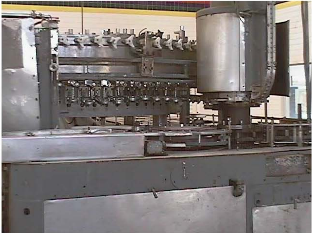
Figura 2.4.7 Llenadora y coronador para botellas de vidrio con hermetapa.
