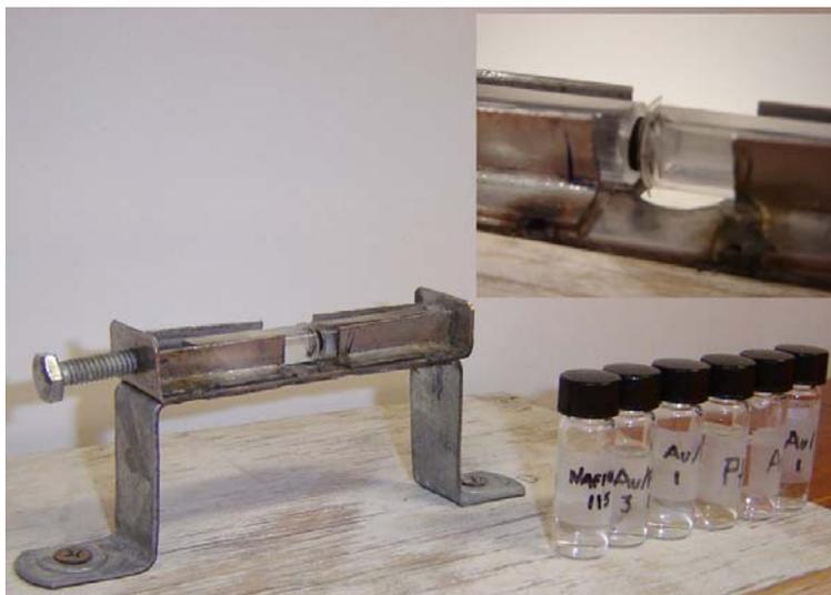
Figura 18, Celda SETP y las distintas membranas evaluadas, en la esquina superior derecha se muestra la posición de la membrana en la celda.
