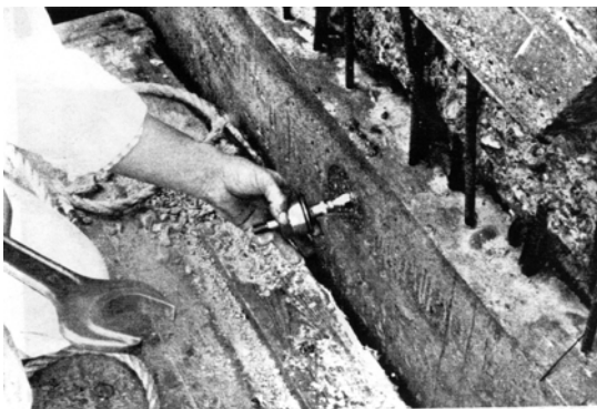
c) Inserción de la campana de extracción
