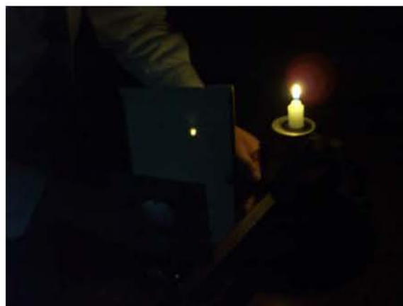
Imagen que se obtiene con un espejo cóncavo.
