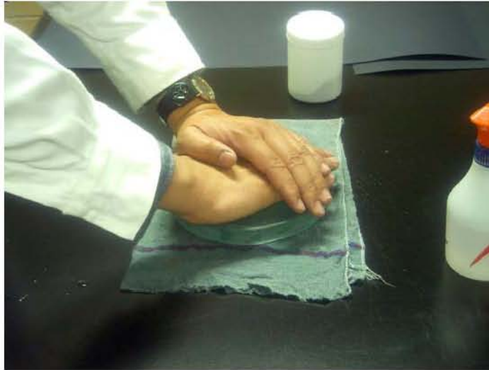
Fig. III.9. La presión se ejerce apoyando las dos manos en el centro del espejo.
