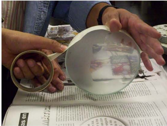
Fig. III.21. La cinta adhesiva se coloca alrededor de la herramienta.
