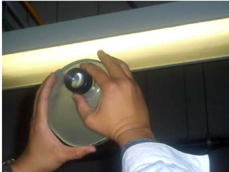
Fig. III.15. Con la lupa se revisa la superficie del espejo.
