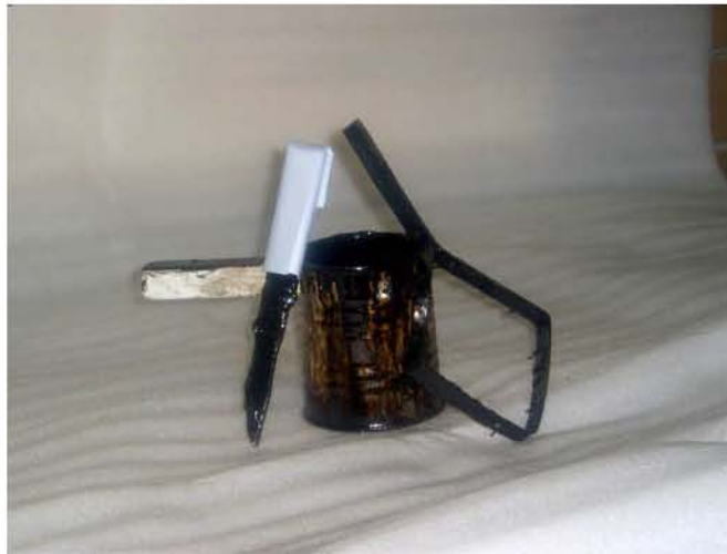
Fig. III.20. La imagen muestra: recipiente, colador y agitador de madera.
