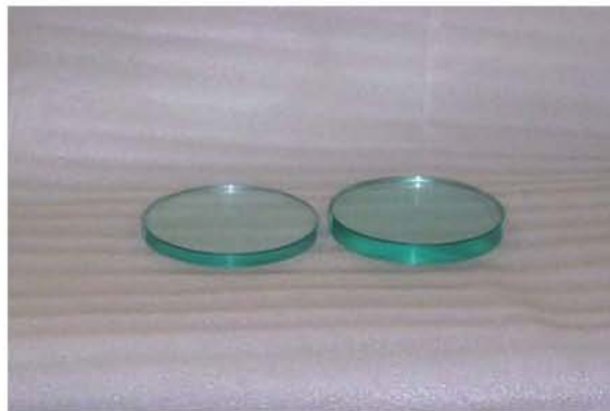
Fig. III.1. El vidrio delgado es la herramienta mientras que el vidrio grueso es el espejo .
