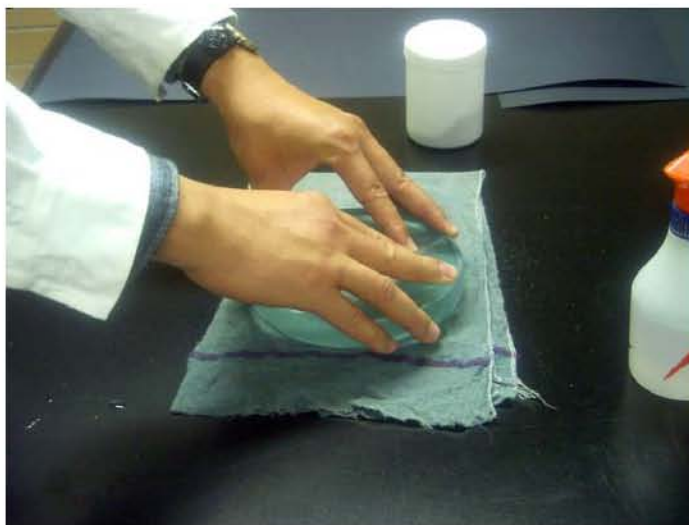
Fig. III.8. La presión se ejerce apoyando las yemas de los dedos sobre el espejo.
