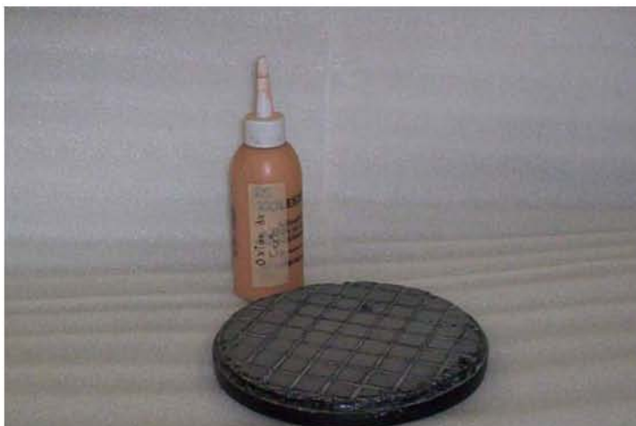
Fig. III.30. Óxido de cerio en una botella (aplicador de tintes) y la herramienta después del prensado.
