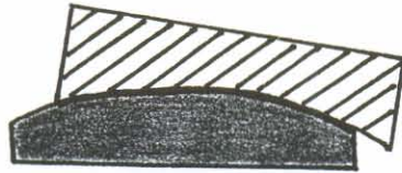
Fig. III.14. El espejo no pierde su concavidad ni la herramienta su convexidad.
