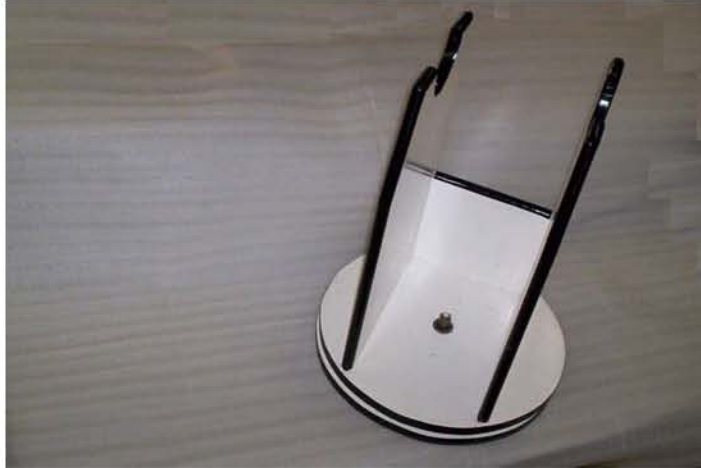
Fig. III.76. La montura dobsoniana terminada y armada.
