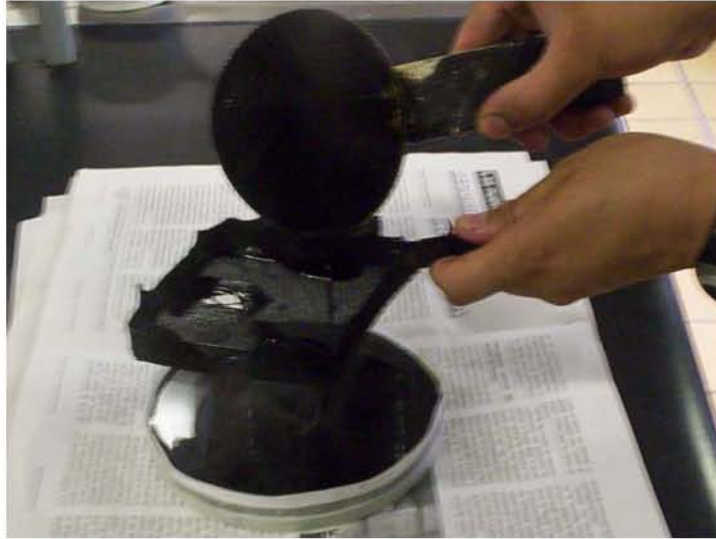
Fig. III.25. Colando la brea en la herramienta.
