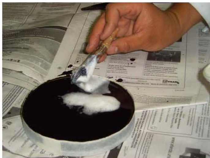
Fig. III.26. Colocando una capa de jabón en la brea.
