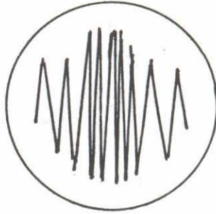
Fig. III.38. El movimiento diametral largo en la orilla y corto en el centro ayuda a desgastar la orilla.
