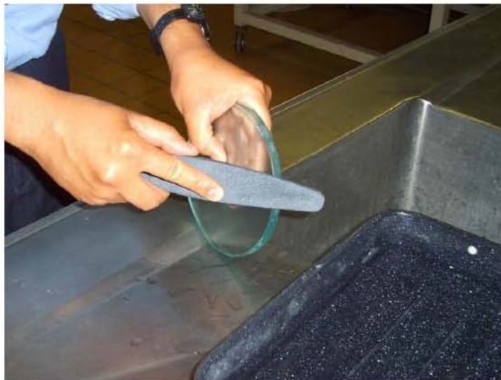
Fig. III.17. Con la piedra de carburo de silicio se esmerila alrededor del vidrio para hacer el canto.
