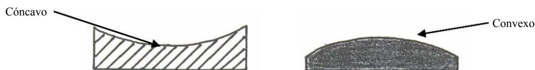
Fig. III.12. El espejo se hace cóncavo mientras que la herramienta convexa.
