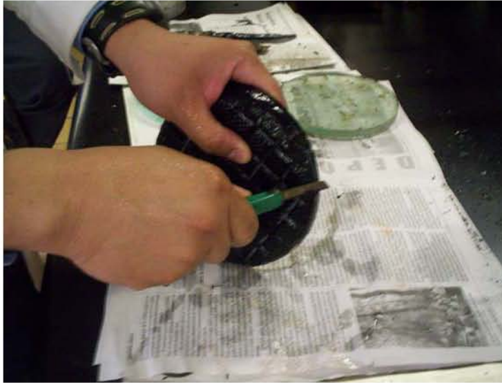
Fig. III.29. La brea se recorta alrededor de la herramienta.
