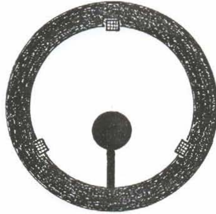
Fig. III.79. El espejo principal se ve completo y el espejo secundario está movido hacia la orilla.
