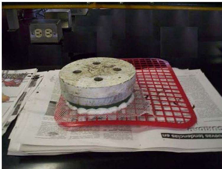
Fig. III.28. Hay que prensar la breca hasta que se enfríe por completo.
