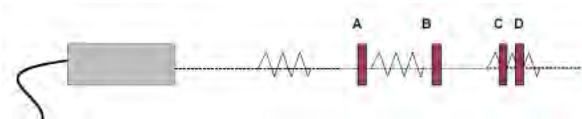
*Fig. 1.6.- Resolución axial Los reflectores A y B están separados por una distancia mayor que la longitud del pulso, de manera que la imagen los reconocerá como objetos diferentes. Sin embargo los reflectores C y D están separados por una distancia inferior a la longitud del pulso, por lo que, en la imagen aparecerán como un objeto único.*
