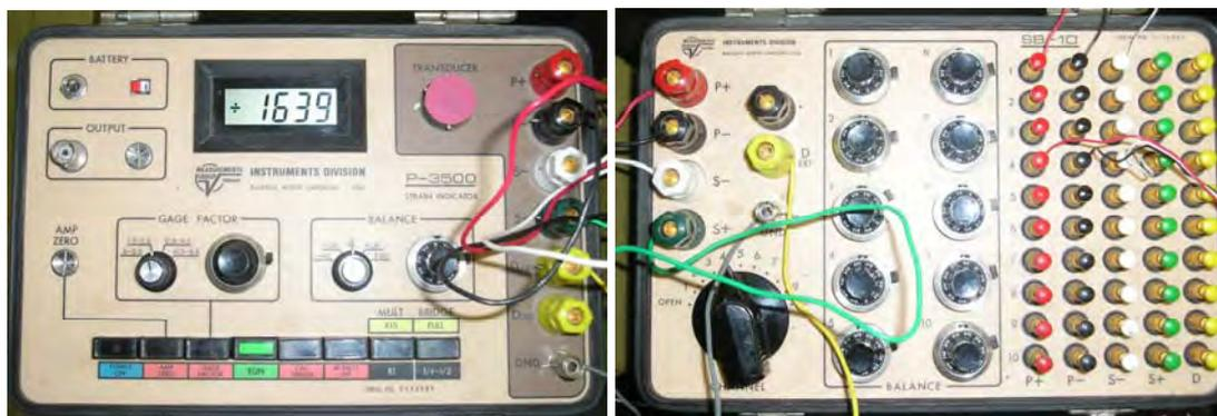
Figura 2.4 equipo de medición de deformación
