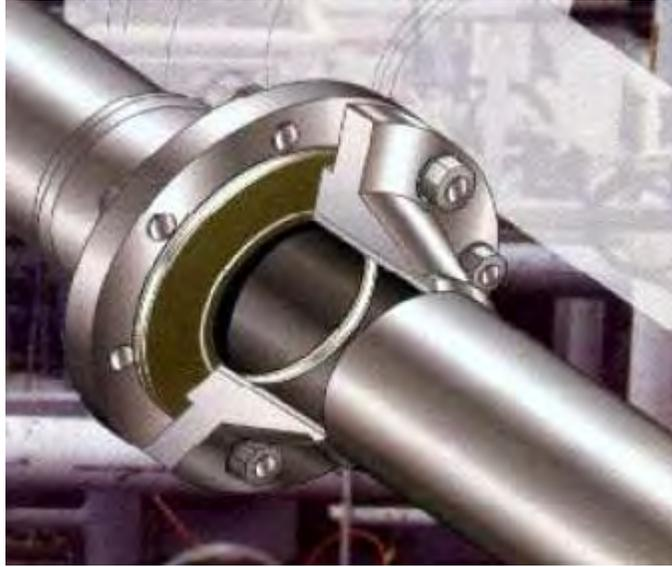
Fig. II.6.2 Representación de la instalación de empaques
