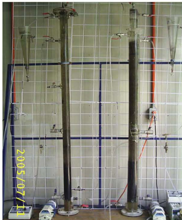
Figura 3.2. Sistema combinado anaerobio/aerobio de lecho fluidizado
