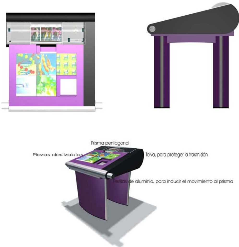
Figura 2.17 Vistas generales y perspectiva de la propuesta final del equipo” Origen de un gen transgénico”.
