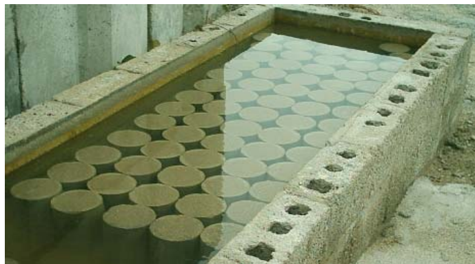
Figura 2.3 Curado de muestras de concreto.
