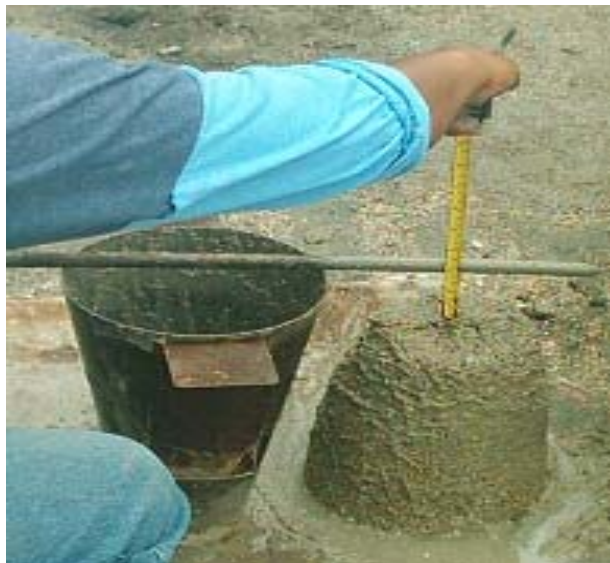
Figura V.2 Realización de prueba de revenimiento.
