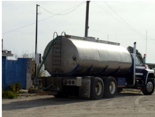
Figura III.19 Pipa para reparto de agua potable.
