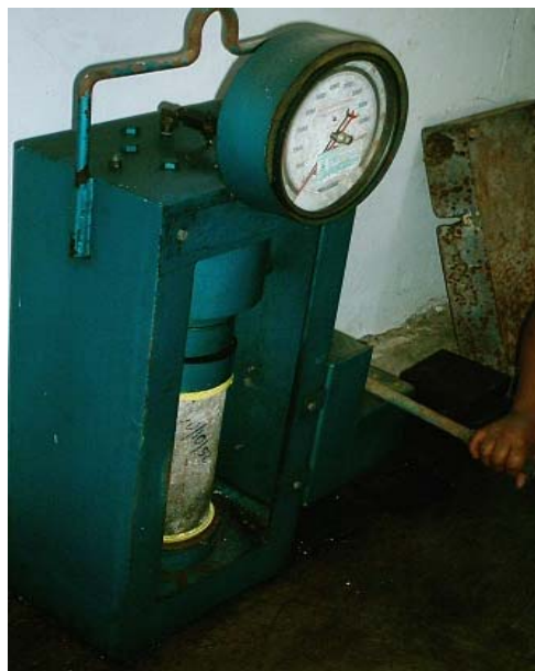
Figura V. 5 Prueba de compresión de cilindros de concreto.
