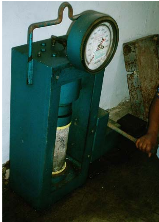
Figura 2.4 Prueba de resistencia para cilindros de concreto.
