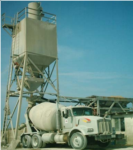
Figura 1.12 Dosificadora de concreto.
