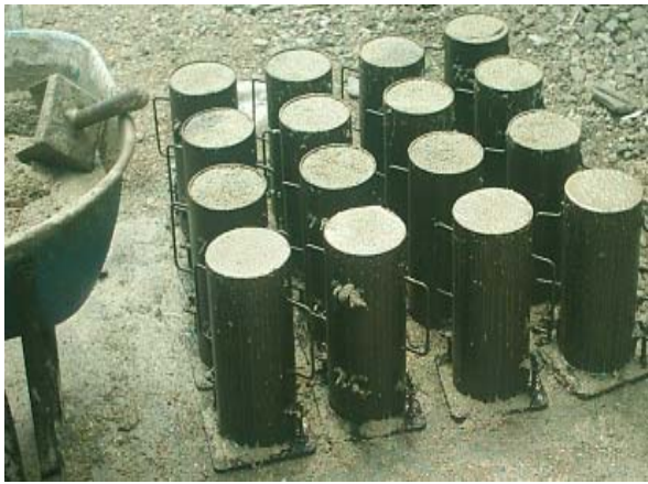
Figura V.3 Cilindros de concreto.
