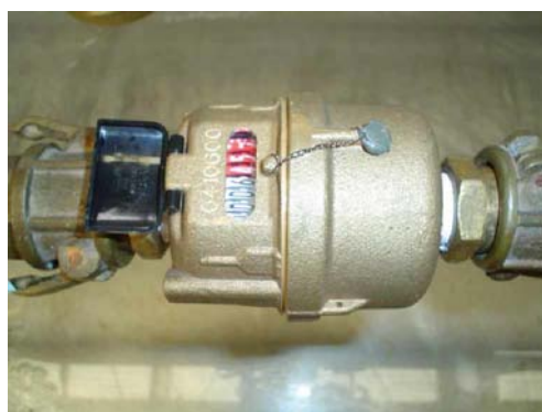
Ilustración A.1 Medidor volumétrico.
