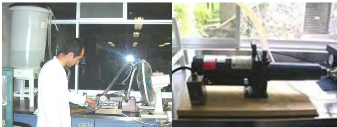
Figura 3-3 Sistema de nanofiltración
