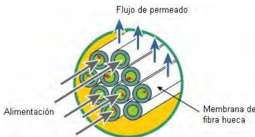
Figura 2-7 Membrana de fibra hueca
