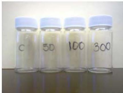
**Figura 7.** Frascos con diferentes concentraciones de fluvalinato
