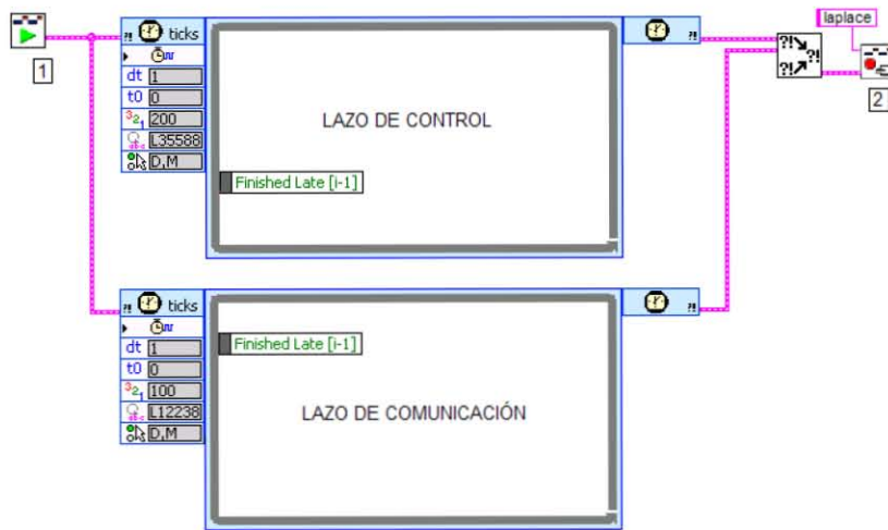
Figura 4.39: Adición de los bloques (1) TraceTool Start Trace VI y (2) TraceTool Stop Trace and Send VI , al diagrama de bloques de los lazos de control y comunicación.
