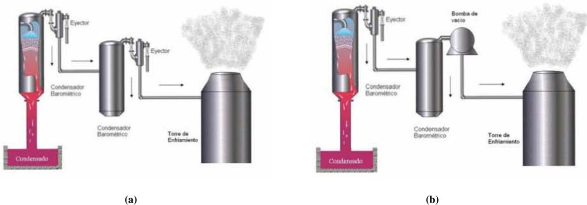
Figura III.12 Sistema de extracción de gases incondensable.
