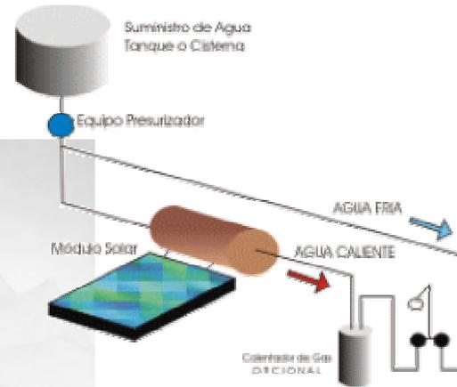
Se instala en cualquier azotea orientándolo hacia el sur. Se conecta al agua fría de su tinaco o salida de presurizador y el agua caliente solar alimenta en serie a su calentador de gas (si lo desea) ya que con este sistema alcanzamos temperaturas de hasta 50°C como temperatura mínima en un día soleado.
